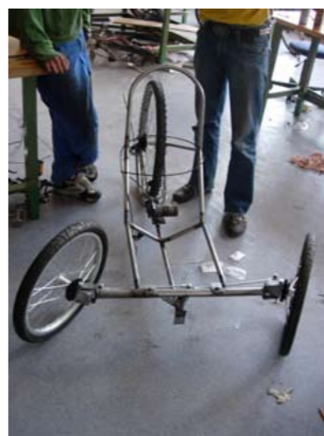
AVANSERT STYRING: Differensiert styring gir større svingutslag på innerste hjul.
