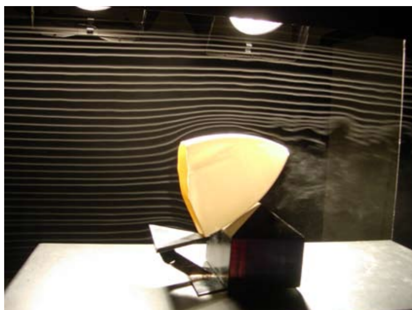
AERODYNAMIKK: Vindskjermen ble testet i røyk-tunnel for for å undersøke luftmotstanden ( drag ).
