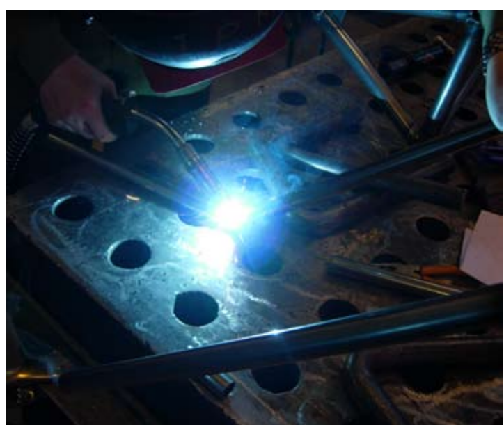
HÅNDFAST: Hele rammen ble sveiset sammen av både nye og gamle deler.
