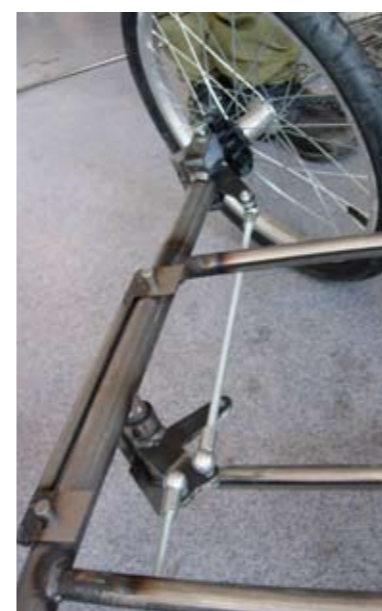
AVANSERT STYRING: Differensiert styring gir større svingutslag på innerste hjul.
